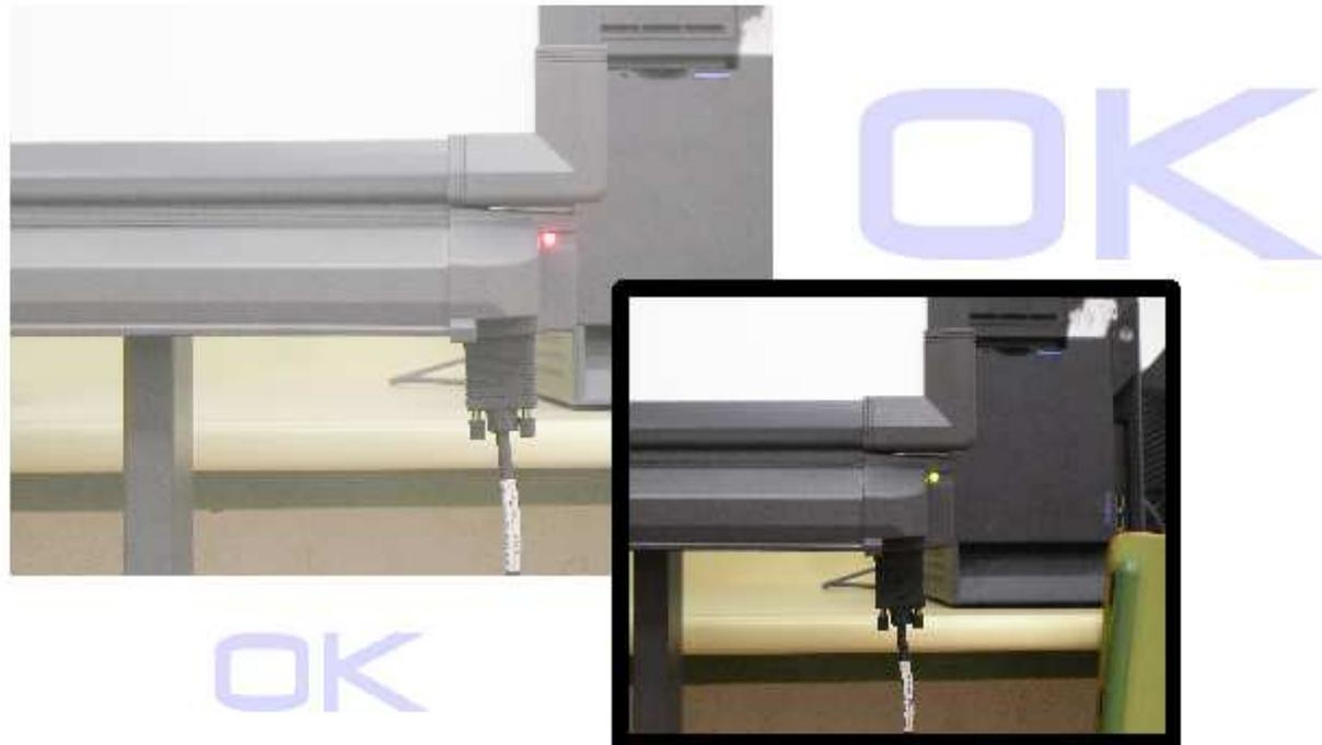
Cuando todo está bien conectado y configurado la luz roja de la conexión de la pizarra se pondrá verde.
